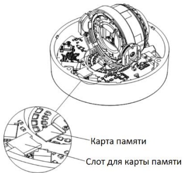
Рисунок 2-3 Установка карты памяти (камера I типа)
