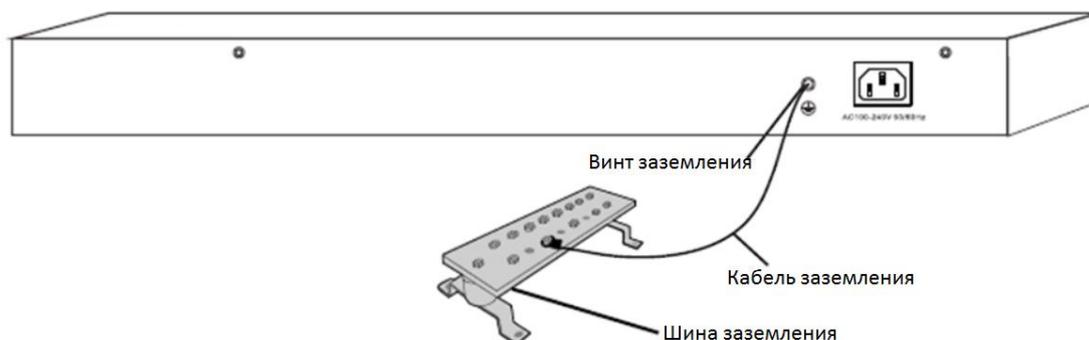
Рисунок 2.5 Подключение шины заземления
