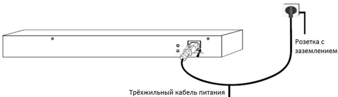
Рисунок 2.8 Заземление с использованием трёхжильного кабеля питания
